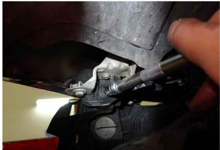
18. Remove the T30 bolt
