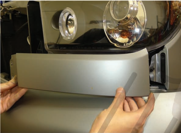
13. Replace the filler trim
