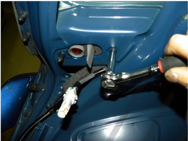
25. Remove the (4) 8mm nuts
