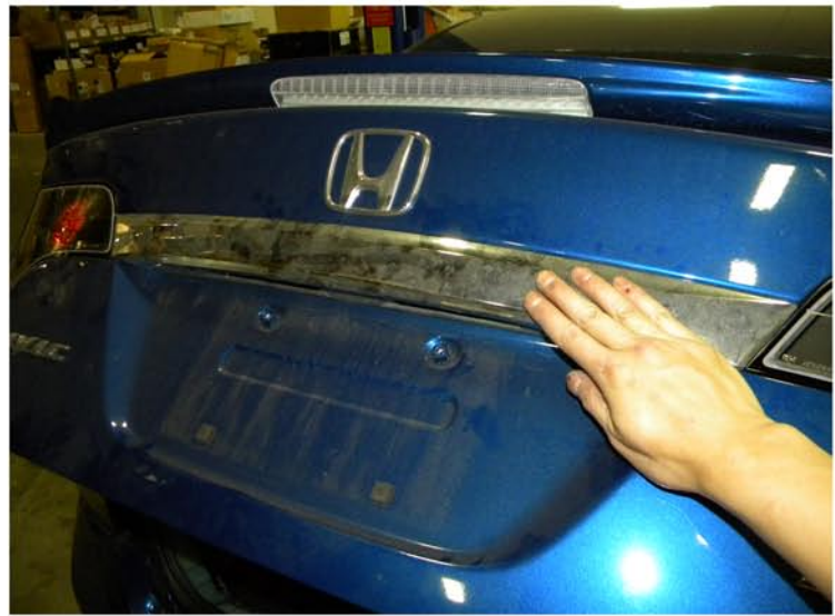
32. Replace the chrome moulding
