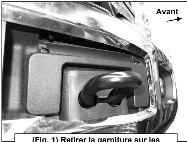
(Fig. 1) Retirer la garniture sur les boulons du pare-chocs
