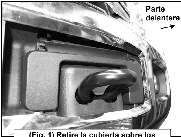
(Fig. 1) Retire la cubierta sobre los pernos del parachoques.
