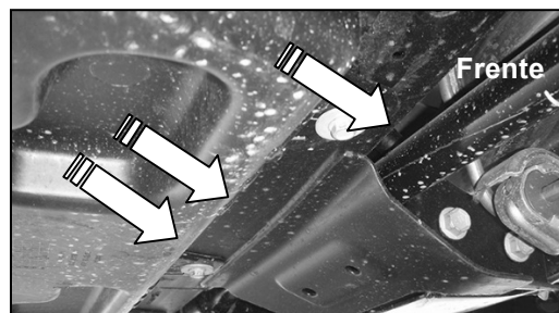
(Fig. 9) Frente del lado del pasajero ilustrado con la cubierta del tanque DEF. Retire (3) los pernos hexagonales para extraer la cubierta
