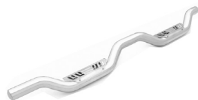
Barre de protection côté conducteur
