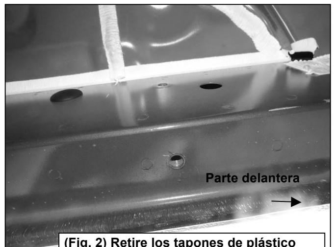
(Fig. 2) Retire los tapones de plástico para descubrir las inserciones roscadas
