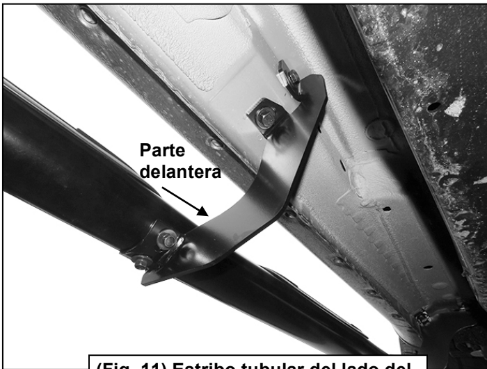
(Fig. 11) Estribo tubular del lado del conductor/izquierdo instalado al soporte de montaje central
