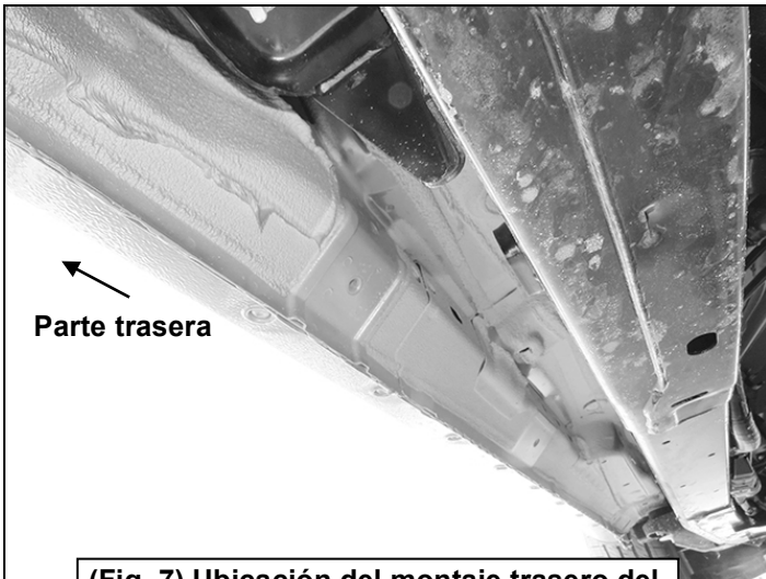
(Fig. 7) Ubicación del montaje trasero del lado izquierdo/del conductor
